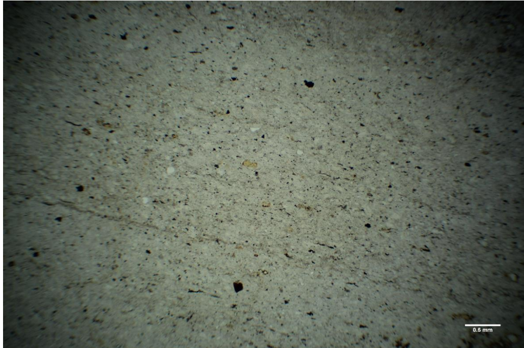
Slika 4-8. Mikropetrografski izbrusak, UZORAK Slap-3 (paralelni nikoli) → vitriklastični tuf građen od dobro sortiranih krhotina vulkanskoga stakla
