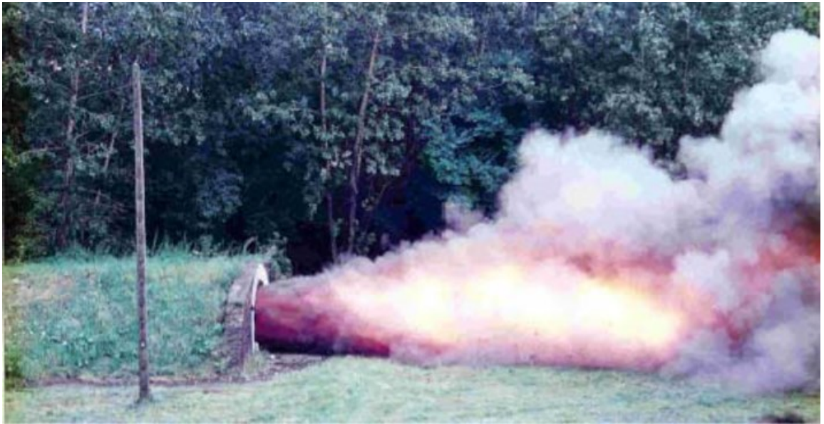
Slika 4-1 - Eksplozija ugljene prašine u testnoj prostoriji (Du Plessis, J.J.L. 2015.)
