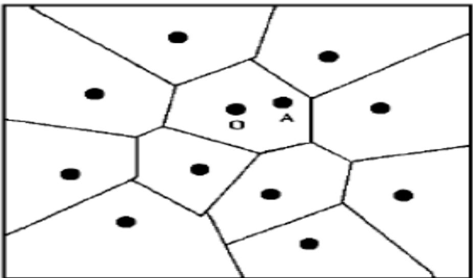
*Slika 2-3. Shematski prikaz Thiessenovoga poligona (npr. LIU et al., 2015)*
