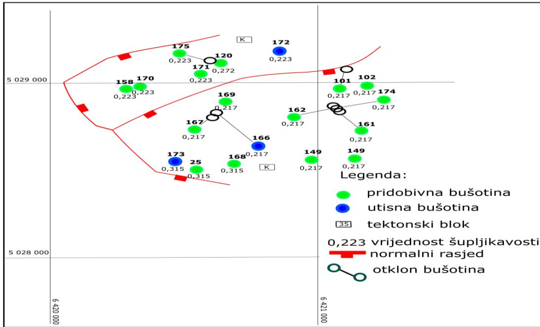
Slika 6-6. Vrijednost šupljikavosti za hidrodinamičku jedinicu „K1“ (iz:<sup>\*</sup>)
