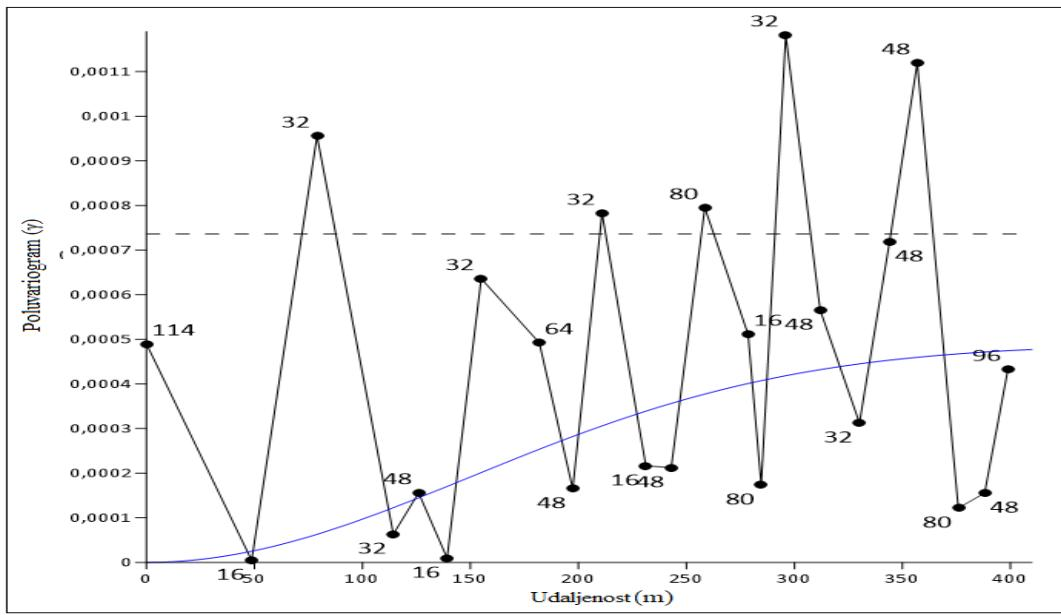
**Slika 6-9.** Eksperimentalni variogram dobiven nakon primjene metode ponovnoga uzrokovavanja
