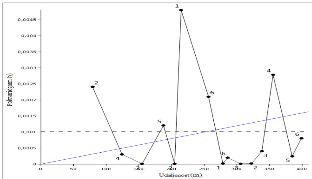
Slika 6-7. Eksperimentalni variogram šupljikavosti hidrodinamičke jedinice „K1“
