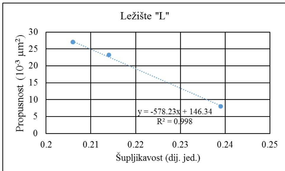
**Slika 5-12.** Odnosi šupljikavosti i propusnosti za ležište „L“
