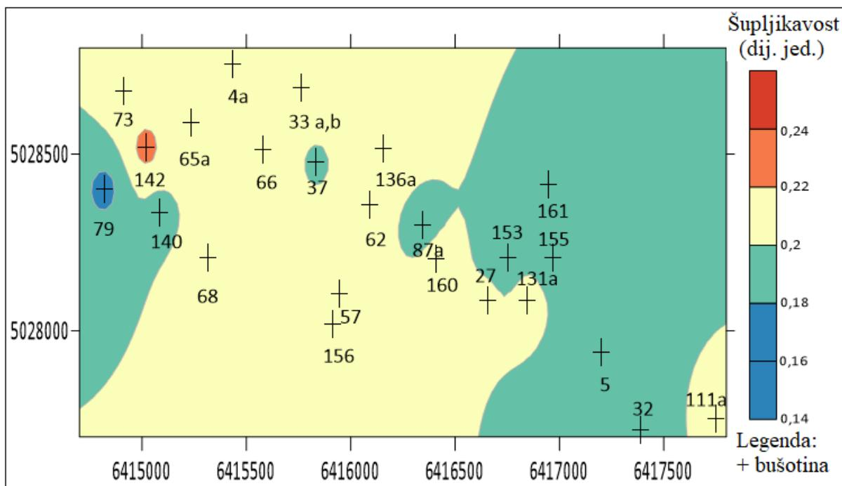
**Slika 5-11.** Prostorni raspored šupljikavosti ležišta „L“ dobiven metodom inverzne udaljenosti iz eksperimentalnoga variograma nakon metode ponovnoga uzrokovavanja
