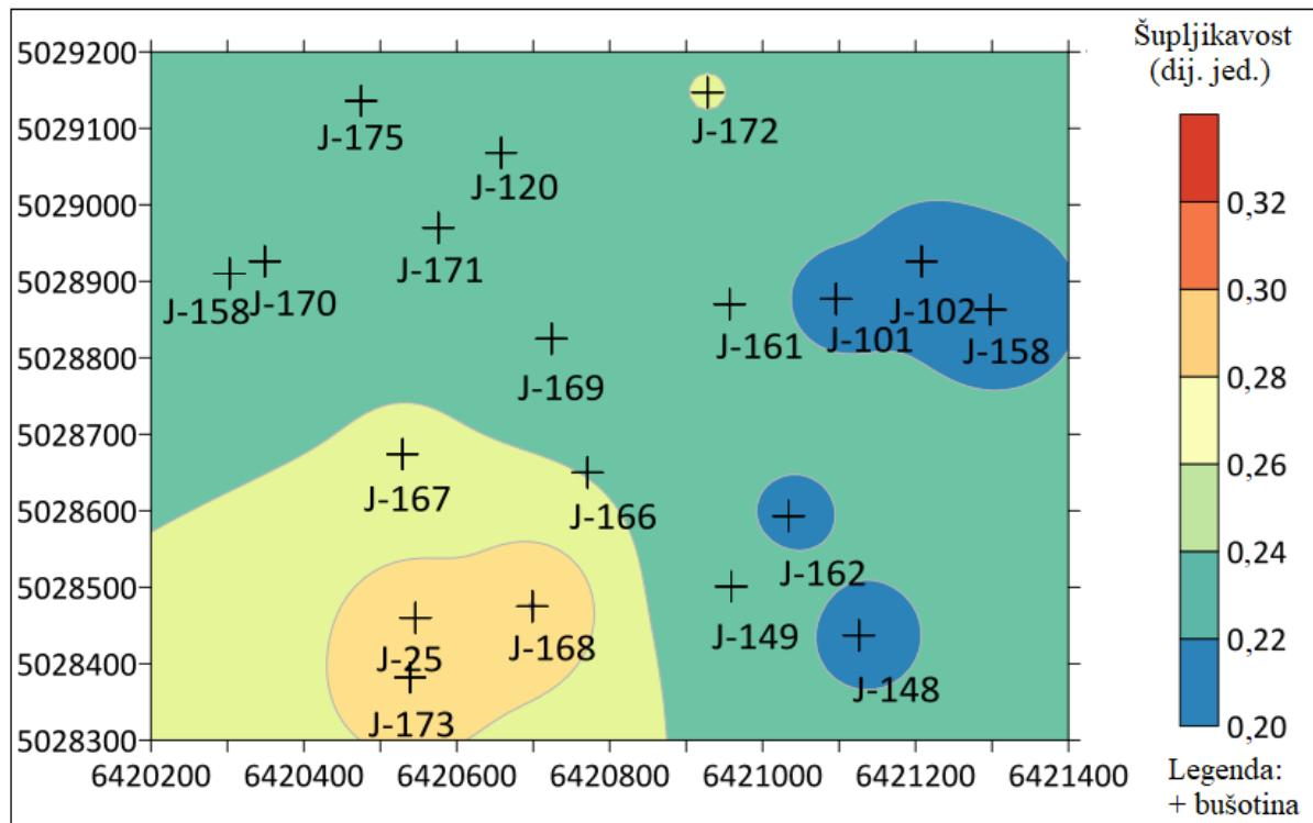
*Slika 6-11. Prostorni raspored šupljikavosti hidrodinamičke jedinice „K1“ dobiven metodom inverzne udaljenosti iz eksperimentalnoga variograma nakon metode ponovnoga uzrokovavanja*
