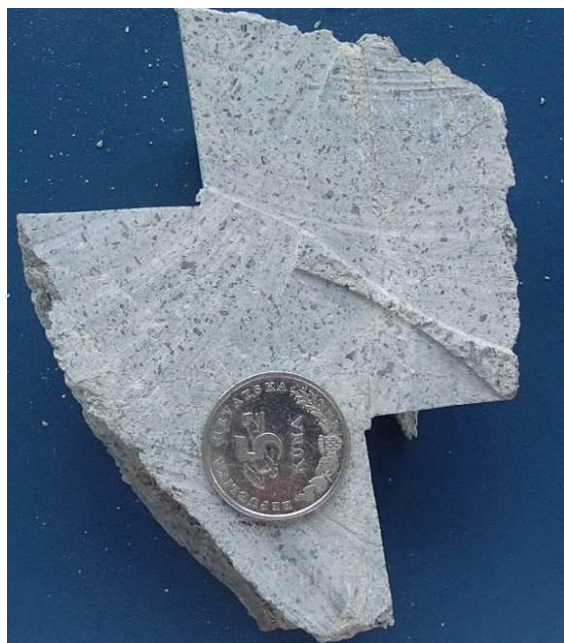
Slika 7.59 Leukokratni dacit porfirne strukture. Bušotina Lacić-1, J-10, interval 3323,5-3326 m.
