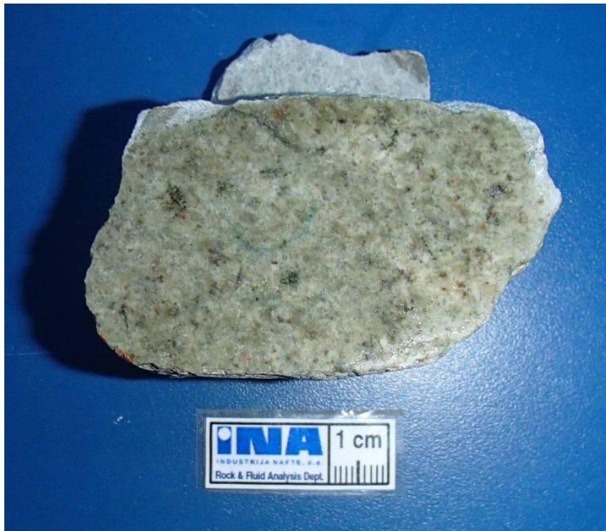
Slika 7.13 Alkalijsko feldspatski mikrogranit Privlake. Stijena je intenzivno alterirana te ima zelenkastu boju. Privlaka-2, J-1, interval 1028 – 1029,5 m.
