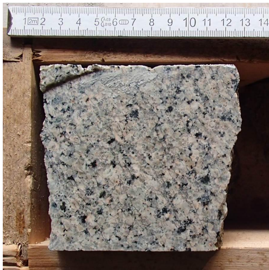
Slika 7.1 Alkalijsko-feldspatski granit krupnozrnate strukture s ružičastim K-feldspatom, sivim kvarcom, sivozelenim albitom, intersticijskim crnim biotitom te sivkastim do tamnim sitnozrnatim nakupinama hornblende, biotita i albita. Prisutne su i tanke crne pukotine ispunjene stilpnomelanom. Privlaka-1, J-5, interval 1140 – 1141,5 m.
