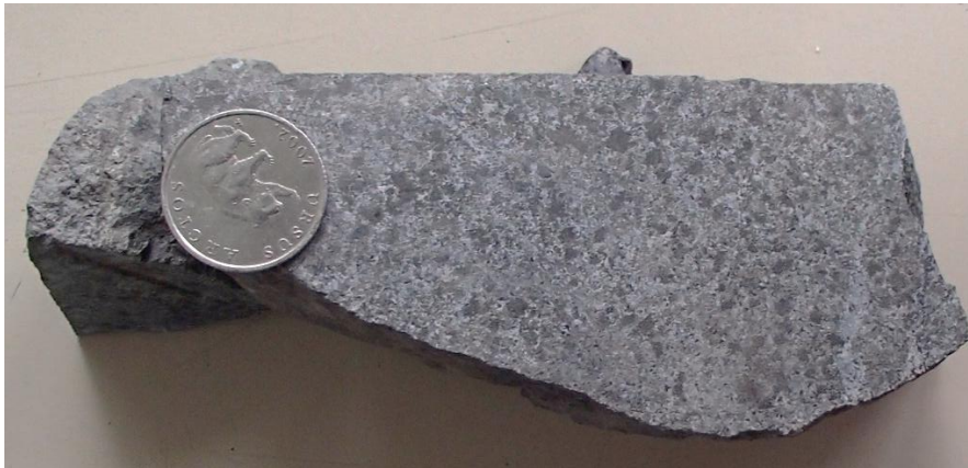
Slika 7.39 Monzodiorit. Vidljive su tamne nakupine hornblende homogeno raspršene u stijeni. Obod-34, J-17, interval 2394-2403 m.
