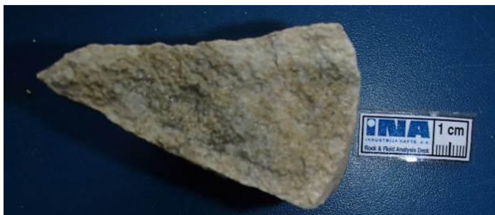
Slika 7.24 Riolit sferulitne teksture. Županja-3, J-2, interval 1427 – 1430 m.
