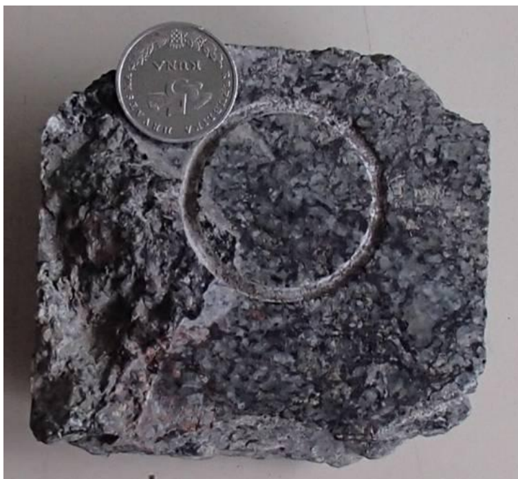
Slika 7.61 Gnajs. Bušotina Obod-34, J-20, interval 2413,5 – 2417,3 m.
