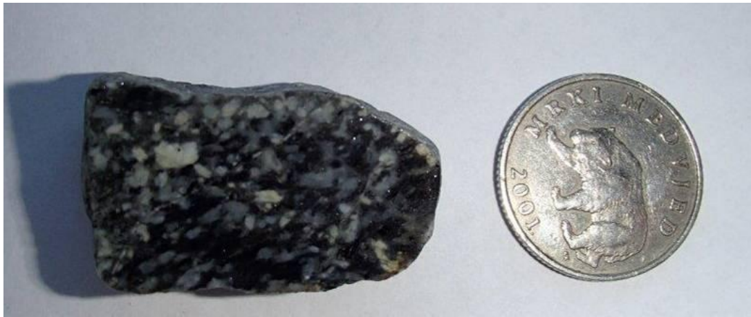
Slika 7.54 Holokristalni dacit. Vidljivi su bijeli fenokristali plagioklasa u tamnoj osnovnoj masi. Lacići-1S, J-9, interval 3000 – 3001,5 m.
