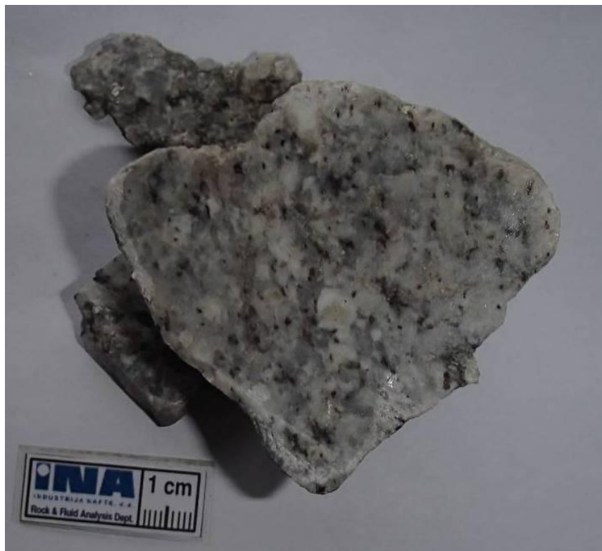
Slika 7.69 Monzogranit s prepoznatljivim bijelim feldspatima, sivim kvarcom i tamnim biotitom. Osijek-2A, J-2, interval 1322,3 – 1326,2 m.
