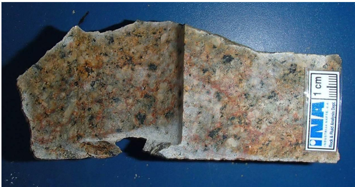
Slika 7.3 Uzorak alkalijsko-feldspatskog granita s izraženim alteracijama. Jasno su vidljive nepravilne isprepletene pukotine ispunjene crvenim hematitom. Privlaka-1, J-3, interval 1010 – 1011 m.
