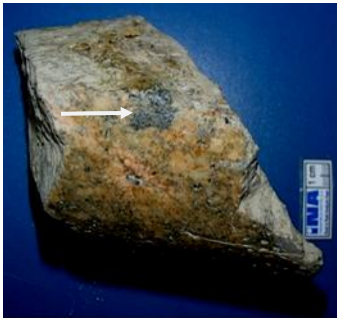
Slika 7.4 Mikrogranularna mafitna enklava (označena strelicom) u porfiroidnom alkalijsko-feldspatskom granitu. Privlaka-1, J-5, interval 1140 – 1141,5 m.
