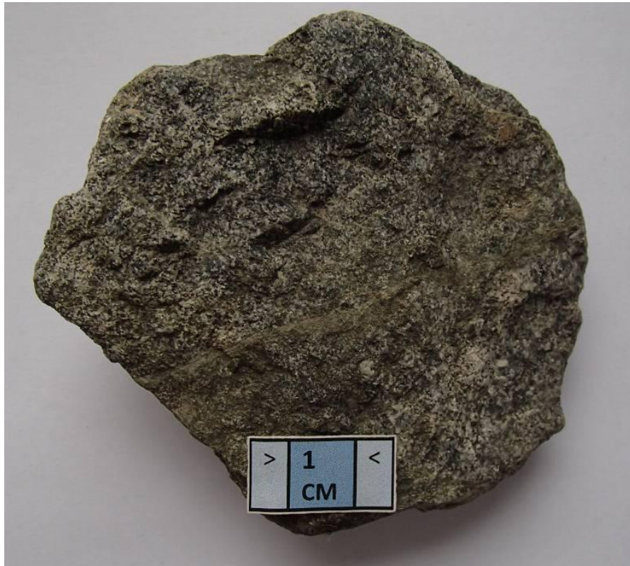
Slika 7.38 Monzodiorit. Stijena je melanokratna zbog velikog udjela feromagnezijskih minerala. U stijeni su vidljive brojne pukotine ispunjene zelenkastim sekundarnim mineralima. Obod-34, J-21, interval 2475 – 2476,3 m.
