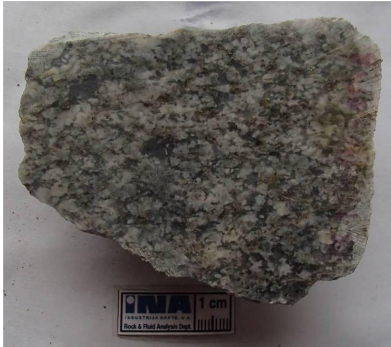
Slika 7.72 Leukogranit. Torjanski Rid-1, J-3, interval 1146 – 1148 m.
