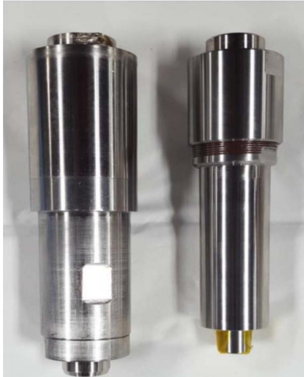
Slika 3-2. Čahure prve generacije (lijevo) i druge generacije (desno) (Jain et al., 2017)
