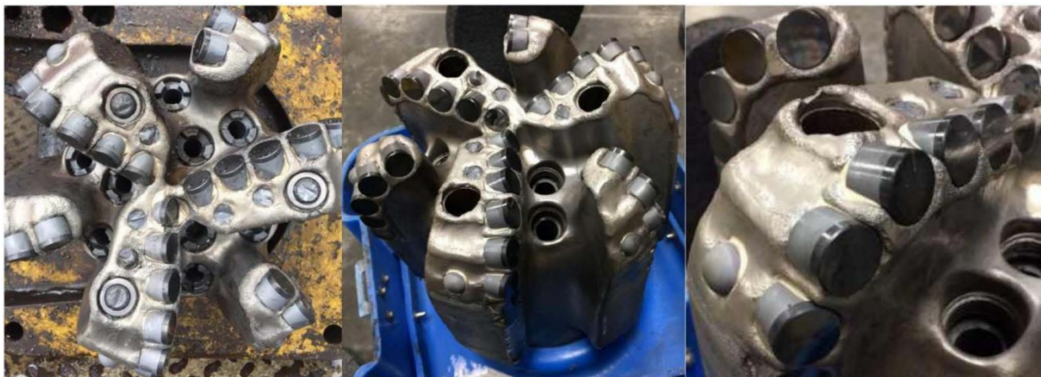
Slika 4-7. Samopodešavajuće PDC dlijeto nakon bušenja prve bušotine s izvađenim kontrolnim mehanizmima (Phillips i Stefanik, 2017)
