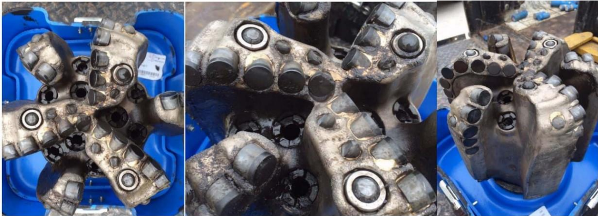
Slika 4-10. Stanje samopodešavajućeg PDC dlijeta nakon bušenja druge bušotine u Južnom Texasu (Phillips i Stefanik, 2017)
