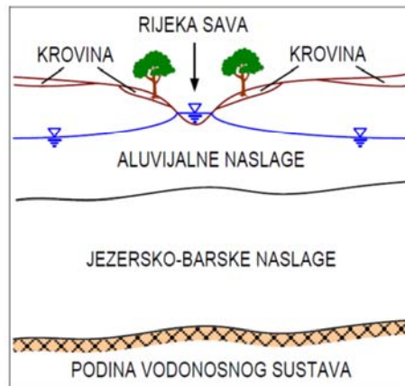
Slika 2.4. Shematski profil zagrebačkog vodonosnog sustava (Posavec, 2006)
