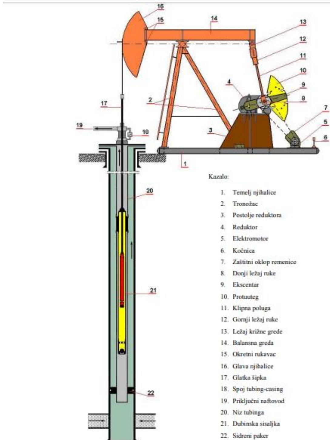
Slika 2-1. Shematski prikaz nadzemne i podzemne opreme proizvodne bušotine opremljene dubinskom sisaljkom s klipnim šipkama (Brkić, 2018)
