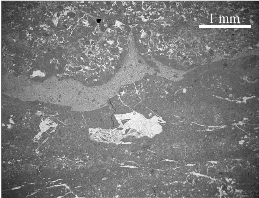
Slika 3.4. Polimodalna građa, mikrokristalastog dolomita uzorka Sy 16b-5 s povijanjem lamina primarnog vapnenca uslijed isušivanja
