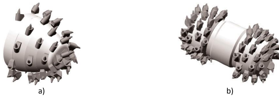
Slika 4.26. Tipovi rotirajuće glave: a) longitudinalna; b) transverzalna (Sandvik Tamrock, 1999)
