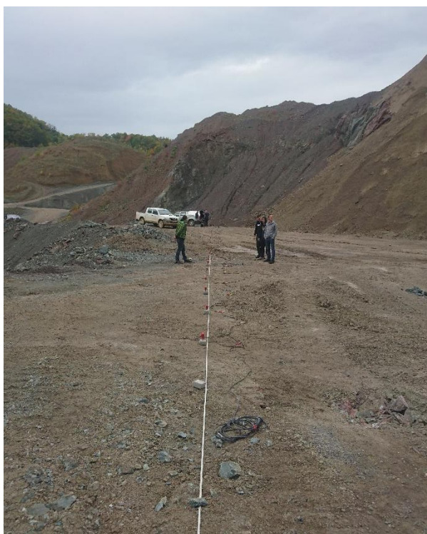
Slika 6.34. Provođenje terenskih geofizičkih ispitivanja na 1. etaži kamenoloma Hruškovec
