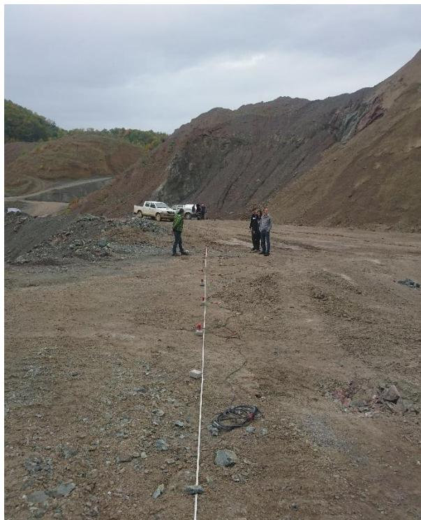
**Slika 6.34.** Provodenje terenskih geofizičkih ispitivanja na 1. etaži kamenoloma Hruškovec
