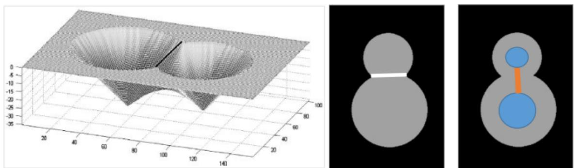
Slika 2-2. Prikaz lijevo: slivovi. Prikaz desno: dva sliva (pore) spojena razvodnicom (Mandzhieva, 2017)
