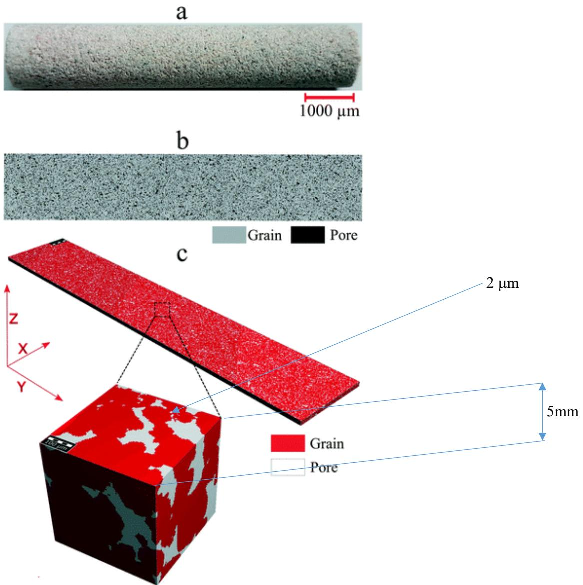
Slika 2-1. Dimenziije digitalnog uzorka (Gaol et al., 2020)
