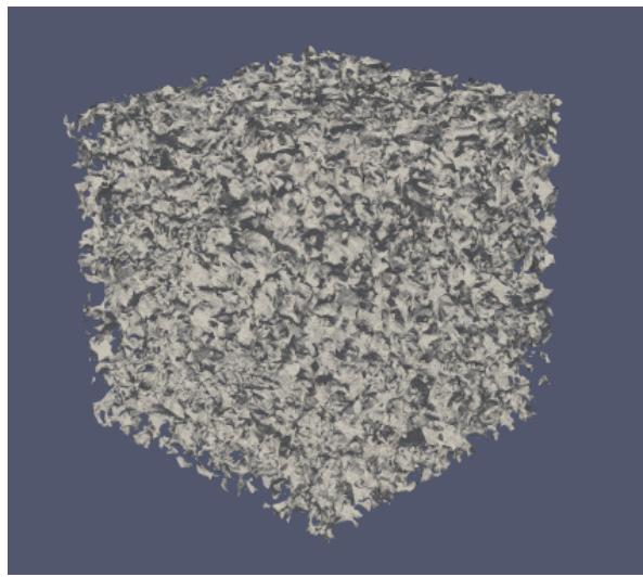
Slika 4-2. Contour filter na RAW uzorku Berea-e
