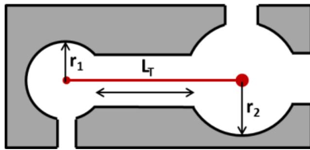
Slika 3-6. Shematski pikaz tipičnog modela pora-grlo-pora (Gostick et al., 2016)
