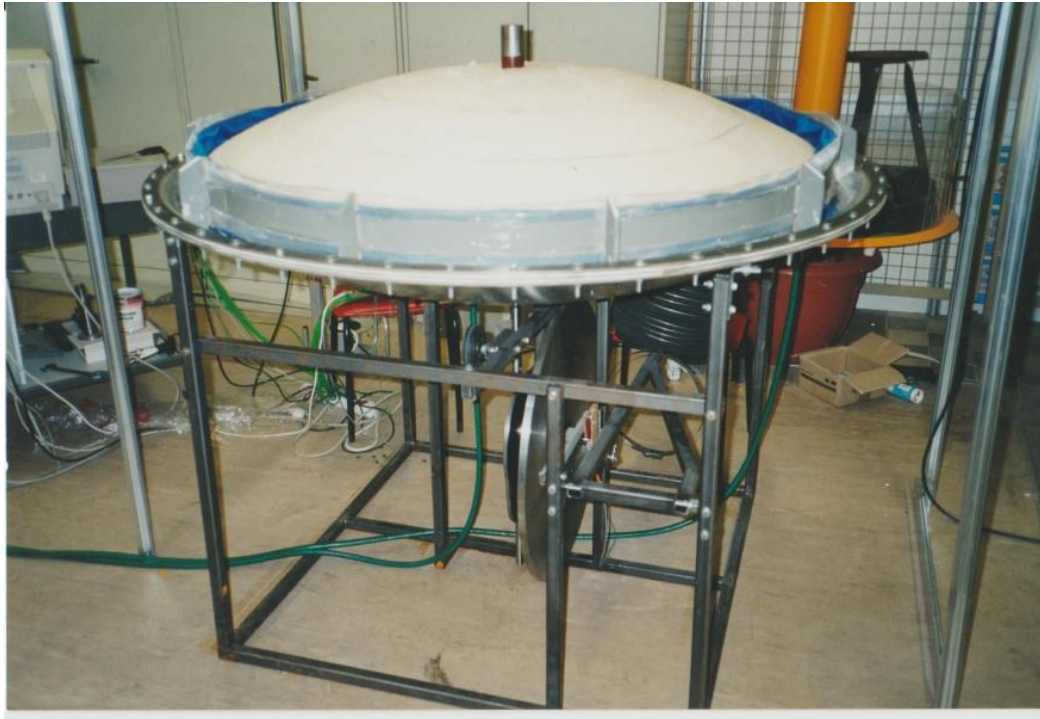
Slika 3-10. Solarni nisko temperaturni Stirling stroj SUNWATER® (Chen, 2004)
