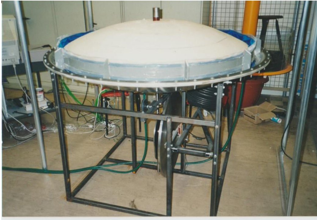
Slika 3-10. Solarni nisko temperaturni Stirling stroj SUNWATER® (Chen, 2004)
