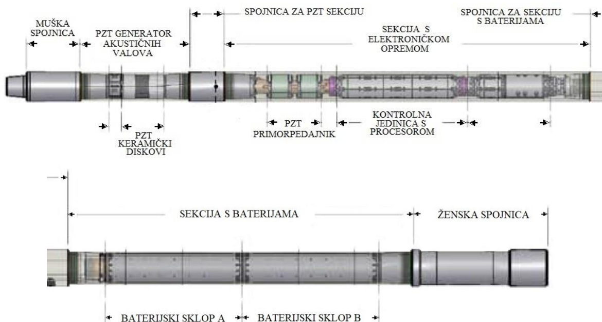
Slika 5-1. Prikaz akustične telemetrijske alatke (Reeves et al., 2011)
