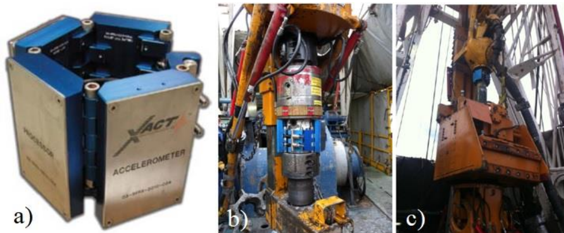
Slika 5-3. prikaz električnog akustičnog prijemnika (a) električni akustični prijemnik pričvršćen na glavnu osovinu vršnog pogona (b) električni akustični prijemnik pričvršćen iznad vršnog pogona (c) (Reeves et al., 2011)
