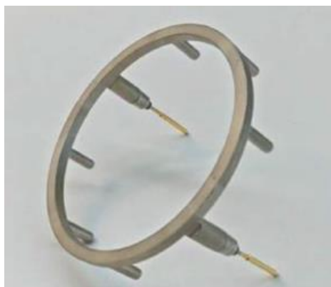
Slika 6-8. Prikaz elektromagnetske rezonancijske spojnice s dvije antene radijske frekvencije (Macpherson et al., 2019).
