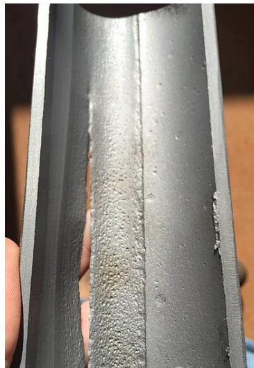
Slika 3-7. Slika pukotine nastale mehaničkim trošenjem (production-technology.org/tubing-rotator, 10.12.2019.)
