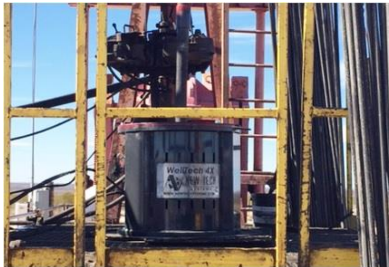
Slika 3-11. Uređaj za inspekciju tubinga prilikom njegovog izvlačenja iz bušotine na površinu (www.newtechsystems.com, 24.3.2020.)
