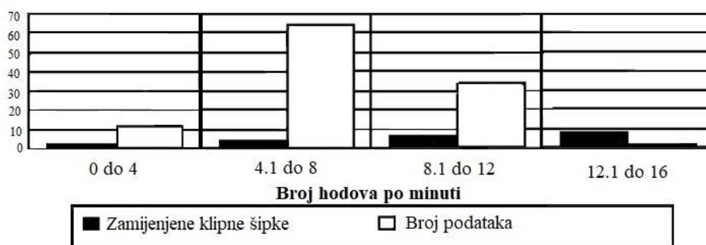
Slika 3-4. Odnos prosječnog broja zamijenjenih klipnih šipki u jednom remontu i broja hodova u minuti klipne sisaljke (Mottramu, 1991)
