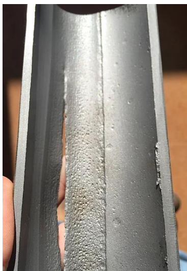
Slika 3-7. Slika pukotine nastale mehaničkim trošenjem (production-technology.org/tubing-rotator, 10.12.2019.)
