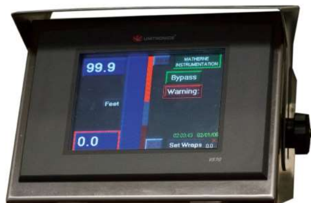
Slika 2-23. Elektronički uređaj za sprječavanje sudara pomičnog i nepomičnog koloturja (Matherne Instrumentation, 2019 d)
