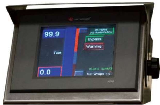
Slika 2-23. Elektronički uređaj za sprječavanje sudara pomičnog i nepomičnog koloturja (Matherne Instrumentation, 2019 d)
