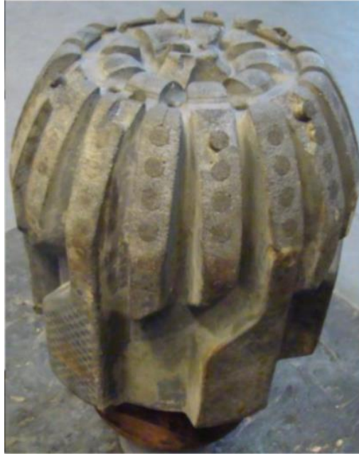
Slika 3-3. Istrošeno dlijeto (Huusgard et al, 2015)
