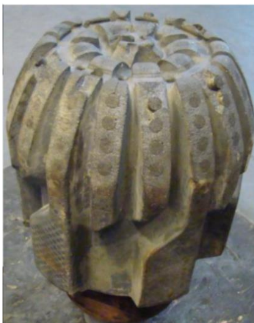
Slika 3-3. Istrošeno dlijeto (Huusgard et al, 2015)
