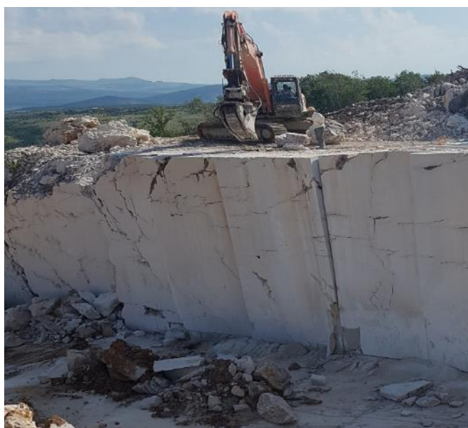
Slika 2-8 Prikaz obaranja bloka hidrauličnom presom
