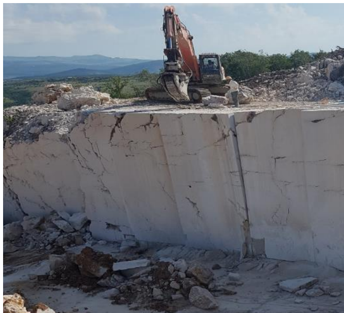
Slika 2-8 Prikaz obaranja bloka hidrauličnom presom
