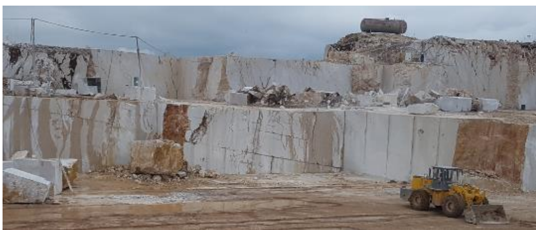
a) otvorene slojne plohe na čelu etaže
