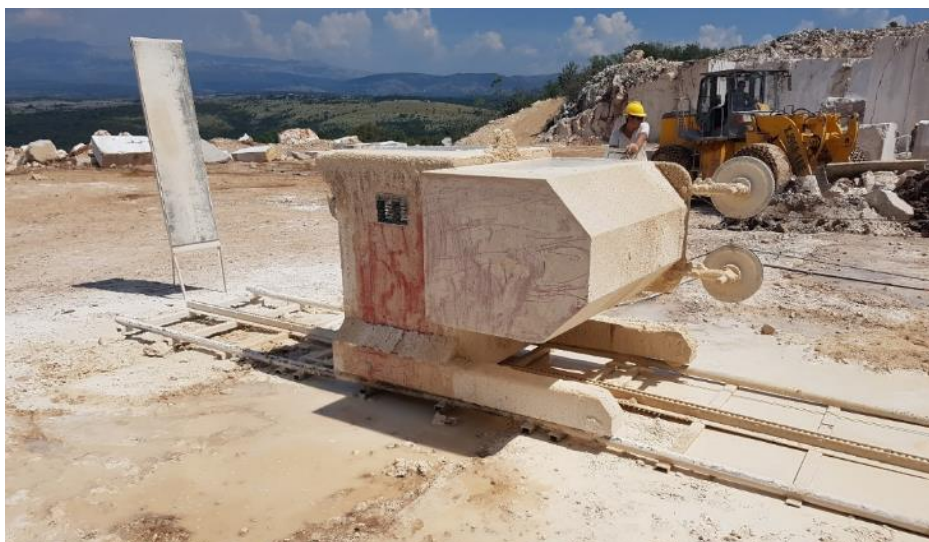
Slika 2-7 Dijamantna žična pila
