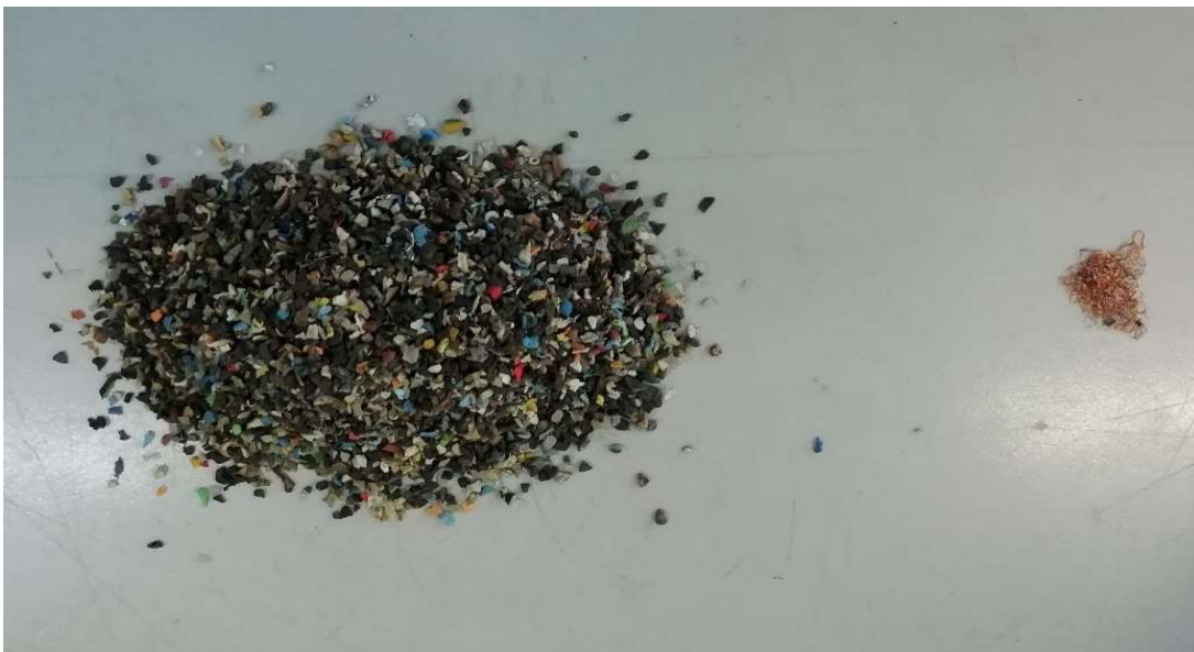
Slika 6-11 Ručno odvojeni bakar od plastike na malom uzorku
