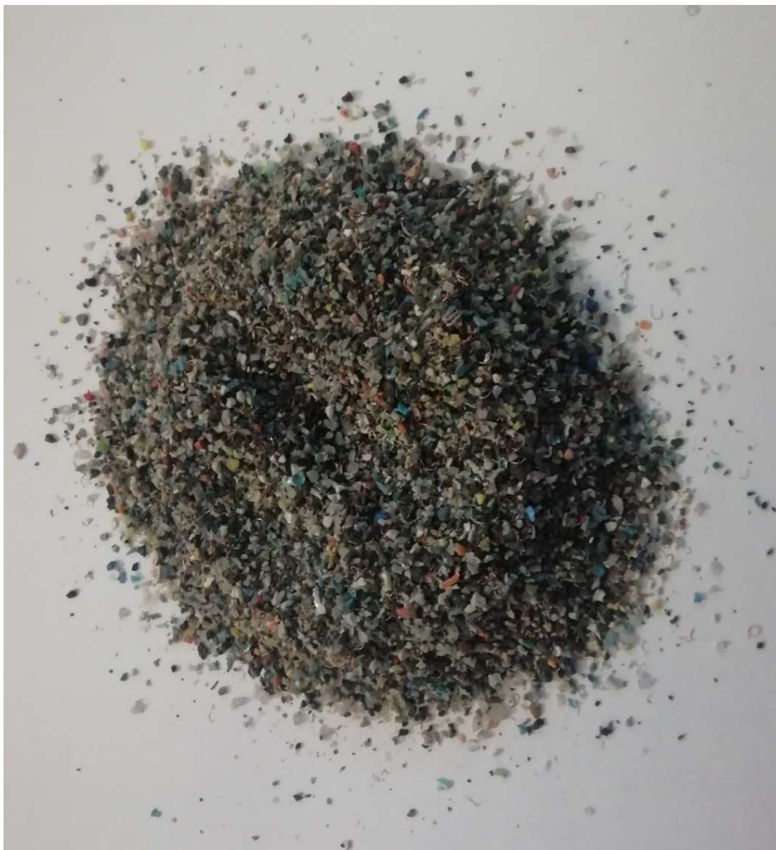
Slika 6-9 Usitnjeni kabele (produkt reznog mlina)
