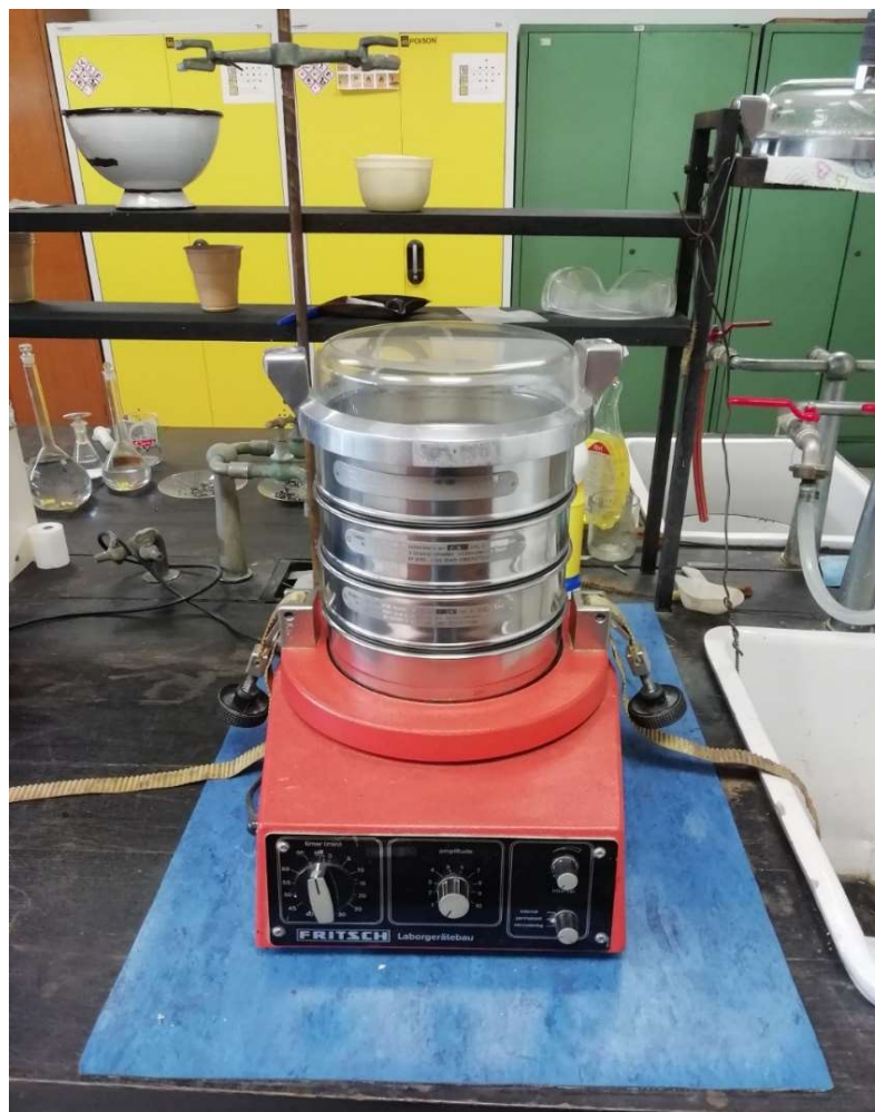
Slika 6-5 Laboratorijsko elektromagnetsko sito FRITSCH Analysette 3 (FRITSCH, 2020)
