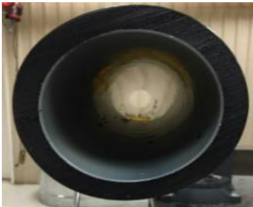
Slika 3-10. Neojačana PA-PERT cijev (Chang i ostali, 2018)
