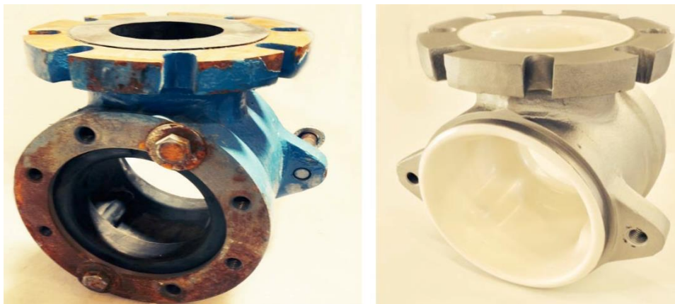
Slika 4-6. Prikaz kuglastog ventila s gumom kao materijalom za zaštitu od korozije (lijevo) i kuglastog ventila čija je unutrašnjost presvučena s PVDF (desno) (Figovsky i Beilin 2010)
