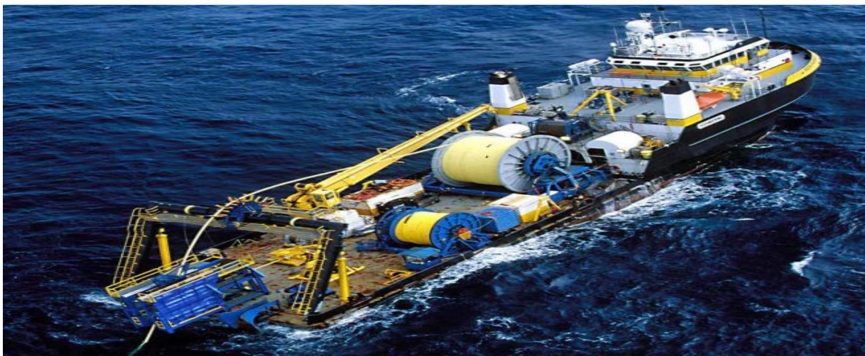
Slika 3-5. Odobalna ugradnja TCP pomoću barži (Cheldi i ostali, 2019)
