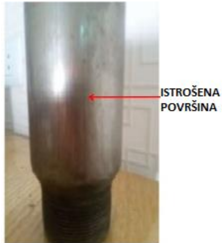
Slika 4 - 1. Istrošena metalna površina klipa sisaljke (Maher, 2016)
