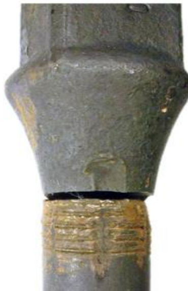
Slika 4 - 2. Oštećenje klipne šipke (Maher, 2016)
