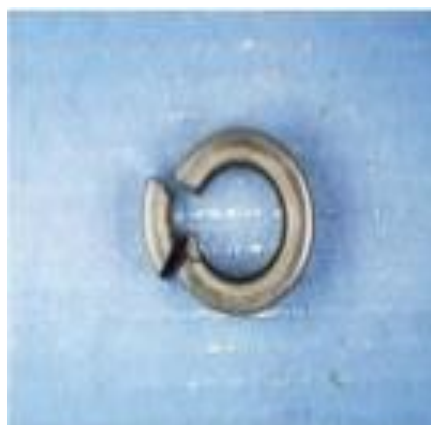
Slika 3 - 2. Lom sjedišta usisnog ventila (Maher, 2016)
