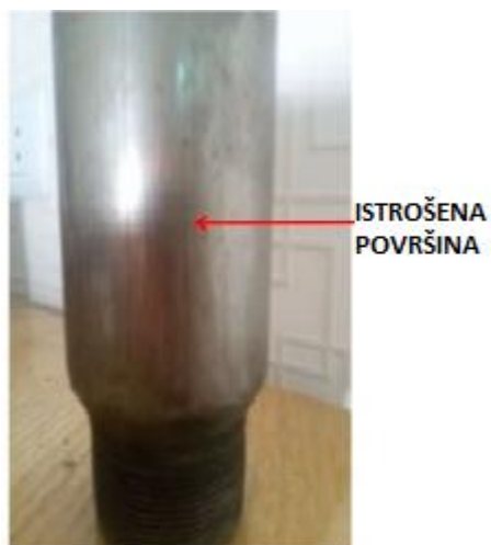
Slika 4 - 1. Istrošena metalna površina klipa sisaljke (Maher, 2016)
