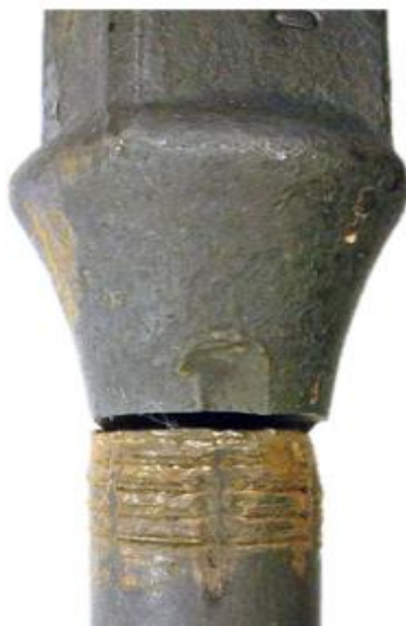
Slika 4 - 2. Oštećenje klipne šipke (Maher, 2016)
