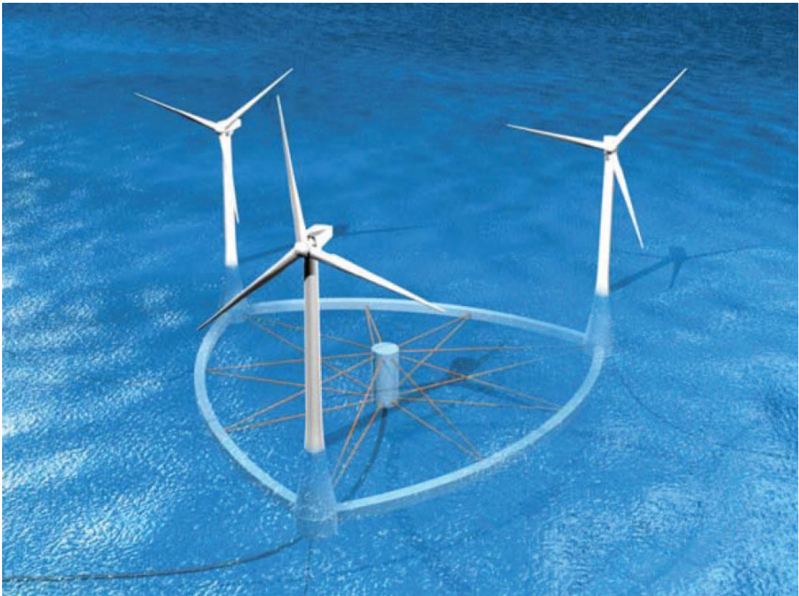
Slika 4-10. Poluuronjiva turbina (Utsunomiya et al., 2010.)
