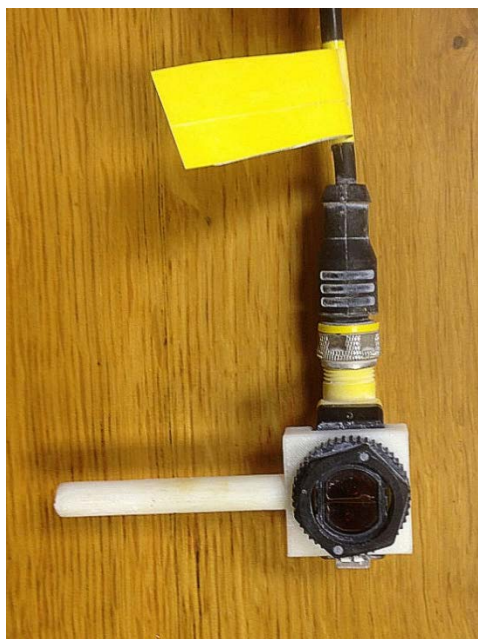
Slika 3.41. Osjetilo za mjerenje broja okretaja World-Beam QS18LLP
