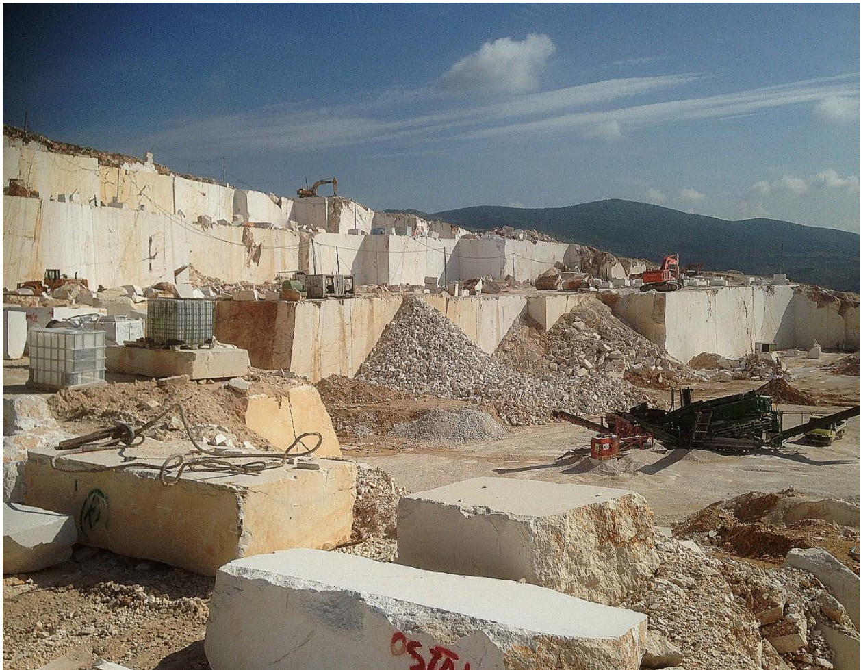
Slika 3.51. Eksploatacijsko polje arhitektonsko-građevnog kamena Redi
