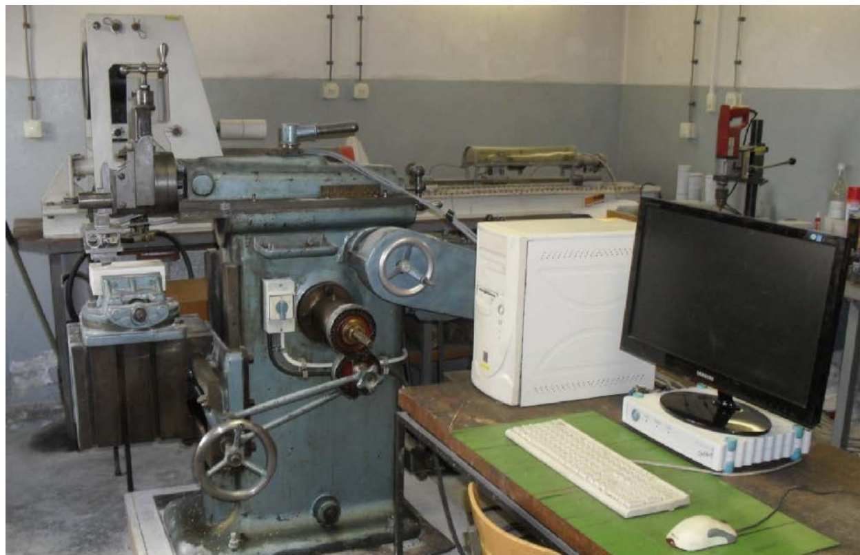
Slika 3.27. Mjerni sustav s troosnim mjernim pretvornikom sile (Korman, 2014)
