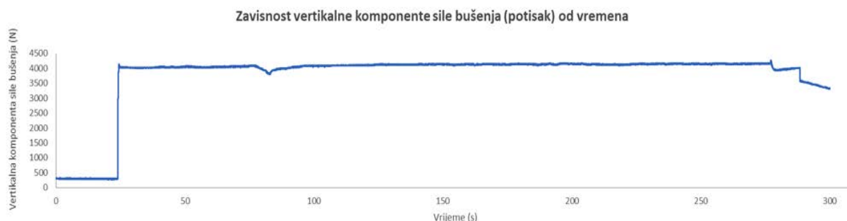
Slika 4.15. Dijagram zavisnosti vertikalne komponente sile bušenja (potisak) od vremena (prvo mjerenje)
