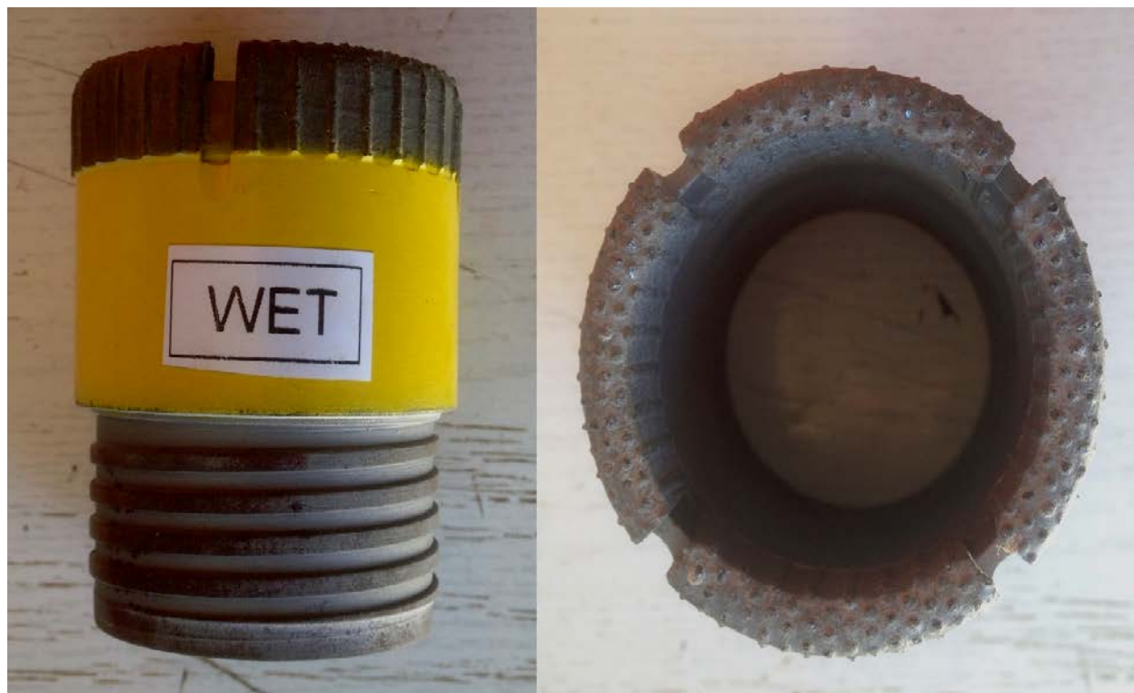
Slika 3.54. Bušača kruna Cordiam Corset
