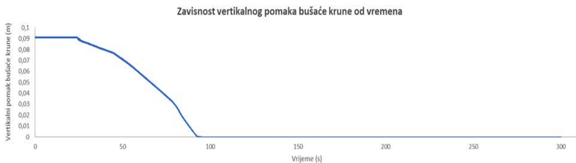
Slika 4.16. Dijagram zavisnosti vertikalnog pomaka bušaće krune od vremena (prvo mjerenje)
