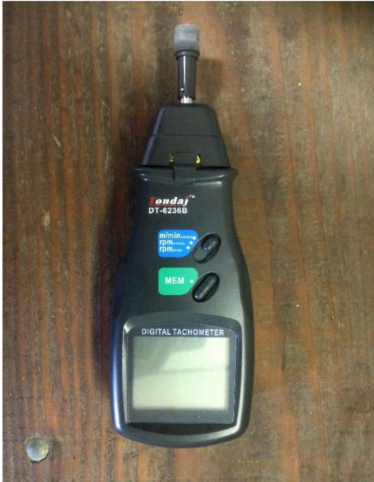
Slika 3.28. Digitalni mjerac broja okretaja Tondaj DT-6236B
