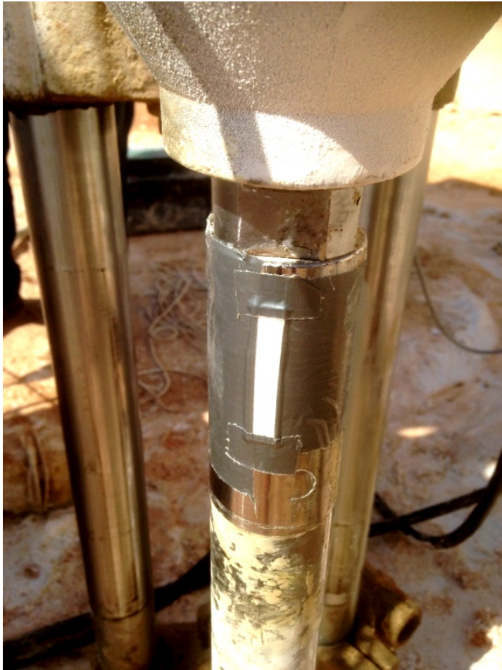
Slika 3.65. Reflektirajuća površina osjetila za mjerenje broja okretaja postavljena na bušaću glavu
