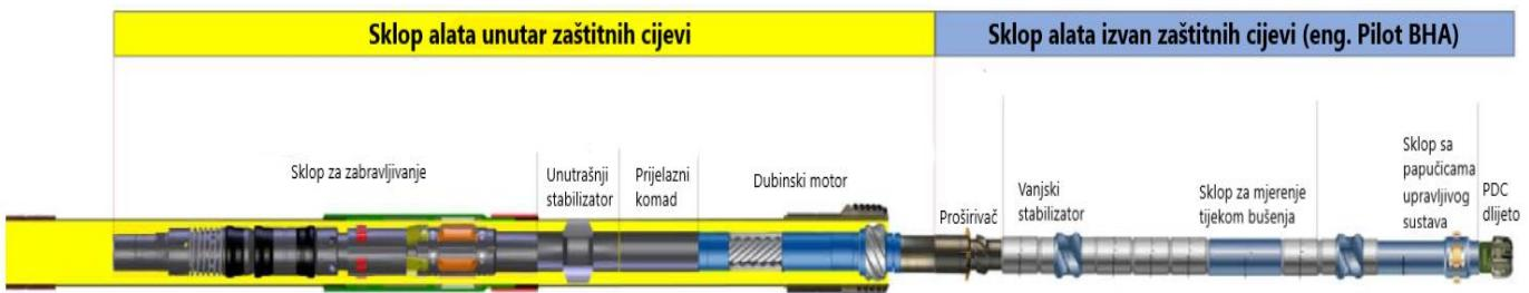
**Slika 4-3.** Sklop alata na dnu pri usmjerenom bušenju uz primjenu zaštitnih cijevi u testnim bušotinama na polju Labaganskoe (Fatkulic et al., 2019)
