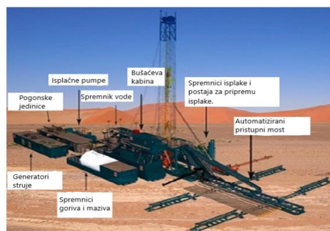
(b) Bušaće postrojenje za bušenje zaštitnim cijevima
