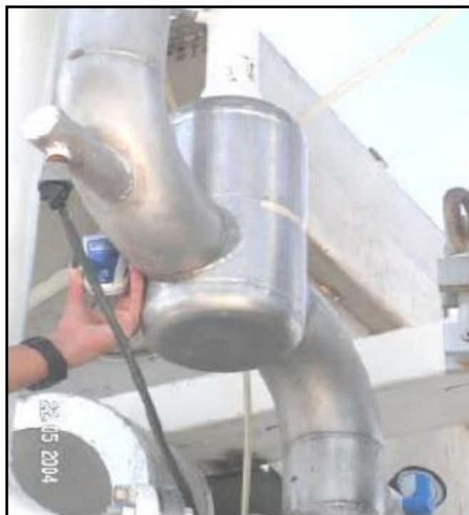
3-9. Oksidacijski reaktor na terenu (Arthur et al., 2005)
