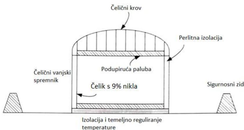
**Slika 3-3.** Nadzemni spremnik za ukapljeni prirodni plin s jednostrukom zaštitom
