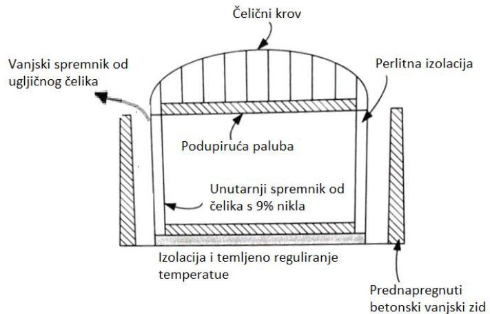
**Slika 3-5.** Nadzemni spremnik za ukapljeni prirodni plin s dvostrukom zaštitom
