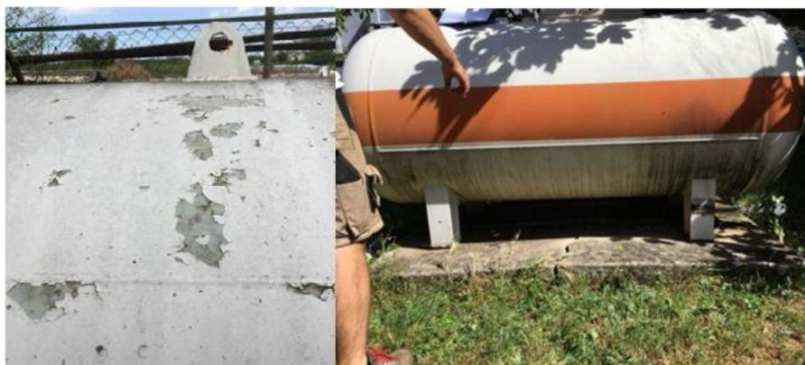
Slika 3-14. Oštećenja spremnika za ukapljeni naftni plin (<http://e-glasnik.tuv-croatia.hr/index.php/tehnicka-inspekcija/item/205-unp-spremnici>)
