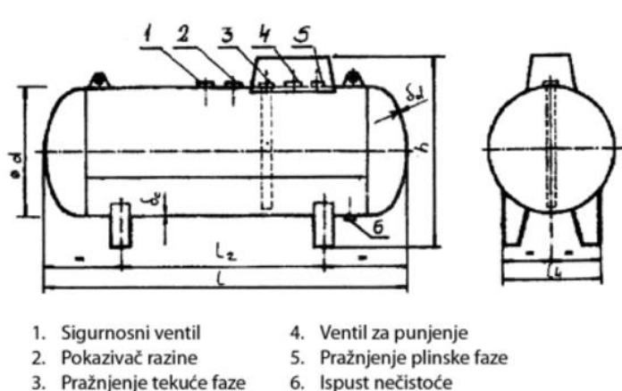
Slika 3-13. Dijelovi spremnika za ukapljeni naftni plin
