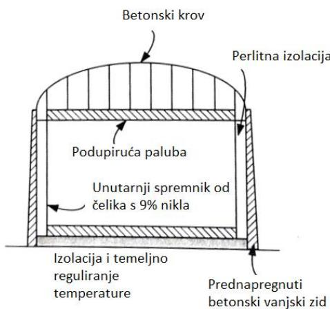
**Slika 3-6.** Nadzemni spremnik za ukapljeni prirodni plin s potpunom zaštitom (Mokhatab et al., 2014)
