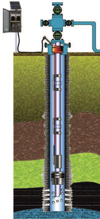
Slika 5- 3. Proizvodni niz opremljen permanentnim dubinskim manometrom
