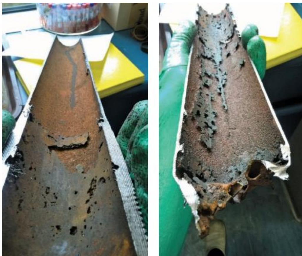
**Slika 3-2.** Izgled proizvodnog niza sa bušotine Iva-X koja proizvodi naftu, s udjelom  $\text{CO}_2$  od 36,5% (Jelić Balta & Borko, 2018)
