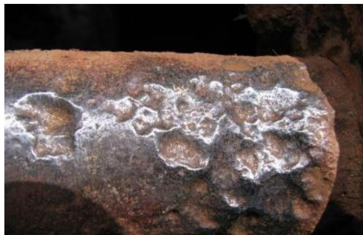
**Slika 4-4.** Vanjska korozija cjevovoda (corrosionpedia.com, 17.8.2020.).
