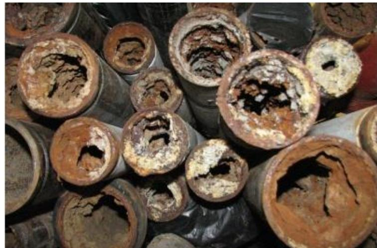
**Slika 4-3.** Unutarnja korozija cjevovoda (corrosionpedia.com, 17.8.2020.).
