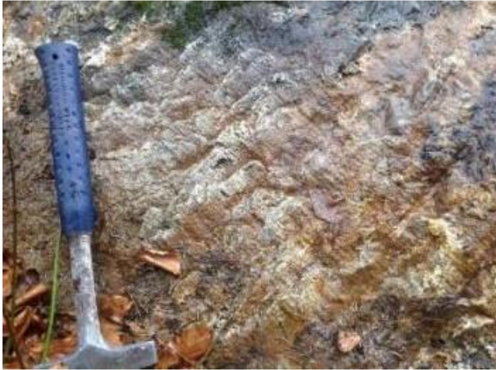
Slika 5-13. Vlaknasti agregati koji nam ukazuju na reversni-desni rasjed (R 216/60). Izdanak se nalazi kod pilane smještene u lijevu obalu rijeke Dobre Točka istraživanja T11, koordinate X=5505118 Y=5028502, Tablica I.
