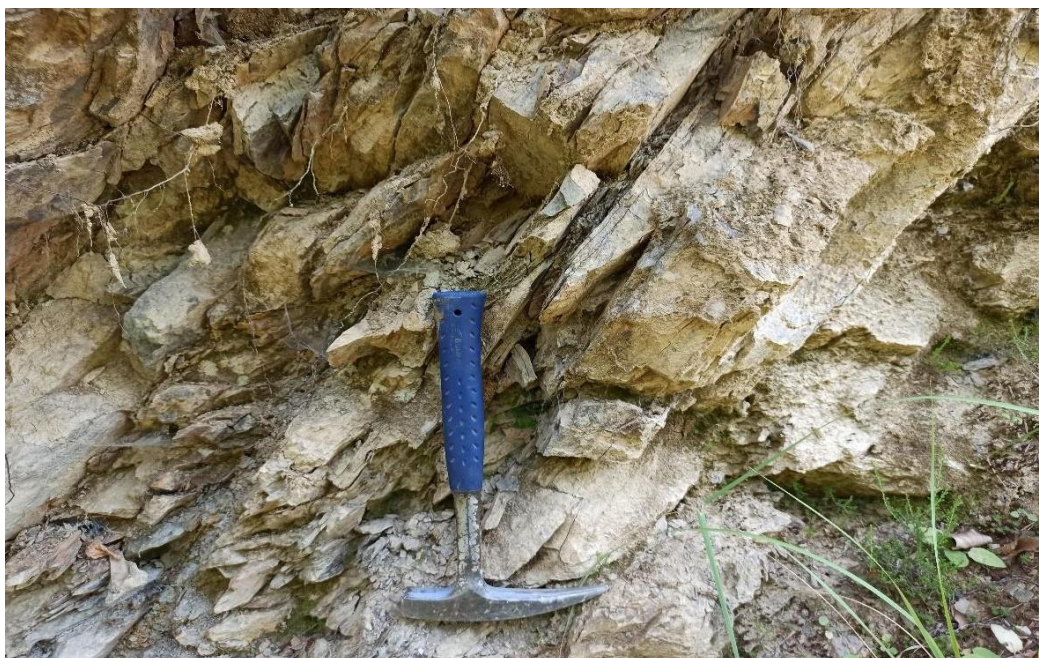
Slika 5-1. Slojevitost u permskim naslagama karakterizirana izmjenom pješčenjaka i šejlova u zasjeku šumskog puta. Točka istraživanja T51, koordinate X=5503504 Y=5029942, Tablica I.
