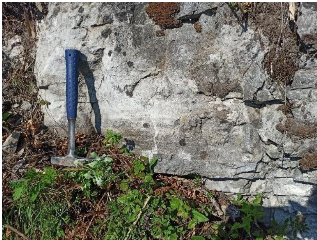
Slika 3-6. Izmjena vapnenaca i dolomita donje jure na izdanku uz cestu (Ul. Hrvatskih branitelja) koja vodi u centar Vrbovskog, Točka istraživanja T27, koordinate X=5505953 Y=5025705, Tablica I.
