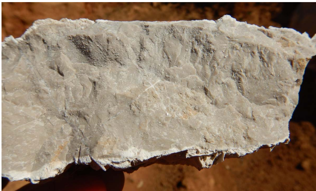
Slika 3- 5 Uzorak s lokacije BS-5, vapnenac mikritskog tipa
