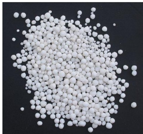
Slika 3-1. Amonijev nitrat za proizvodnju ANFO eksploziva ( https://medicroslavl.ru/ )
