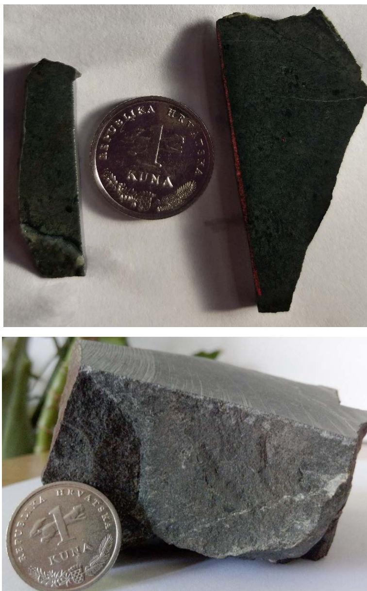
Slika 5-5. Uzorak MVIM 21C (dolje). Pločica od koje je napravljen mikroskopski preparat (gore).
