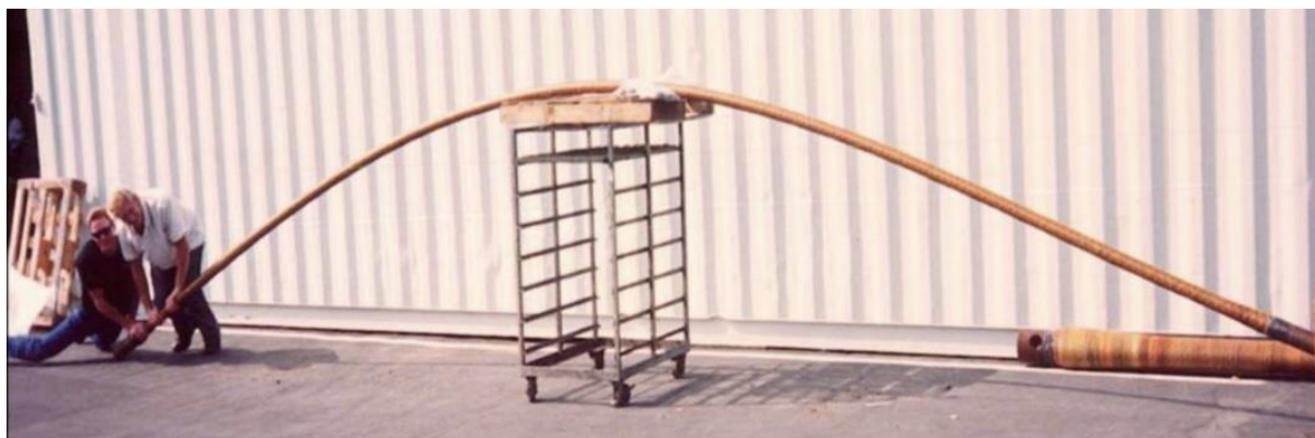
Slika 3-4. Fleksibilnost kompozitne bušaće šipke ( https://www.osti.gov/servlets/purl/1034754 )
