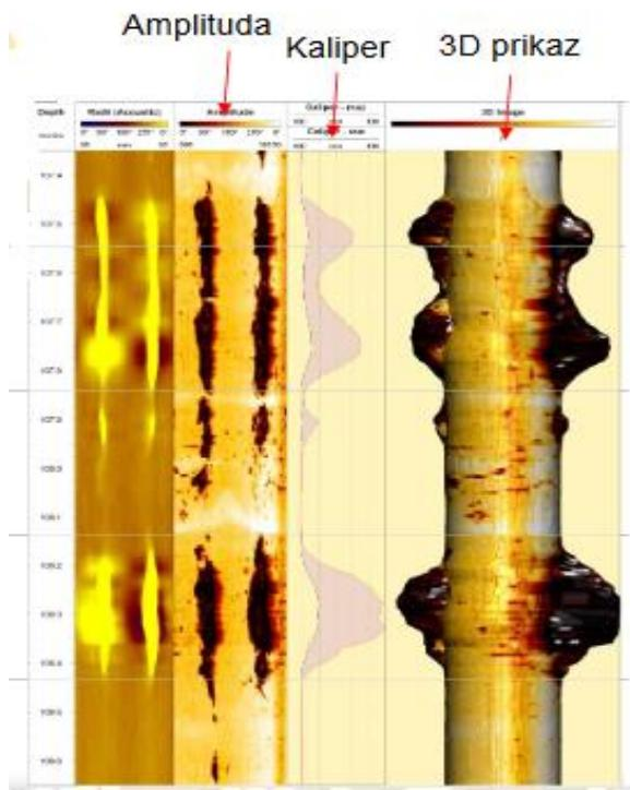
Slika 5-3. Slika izrađena praćenjem amplitude reflektiranog vala
