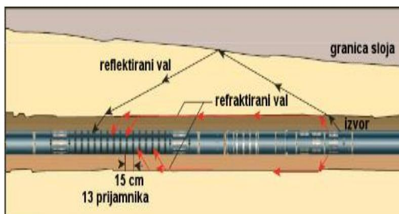
Slika 5-1. Zvučni skener (Haldorsen, 2007)
