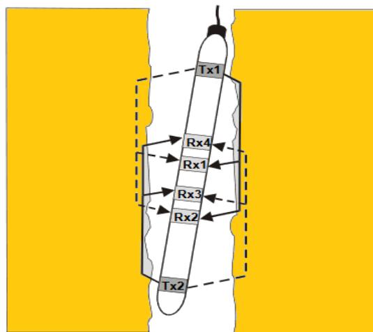
Slika 3-2. Sonda za kompenziranu zvučnu karotažu (Glover, 2012).
