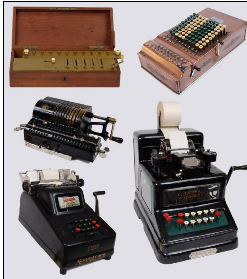
Slika 2-5 Različiti primjerci mehaničkih računala (Wikipedia, 2012)
