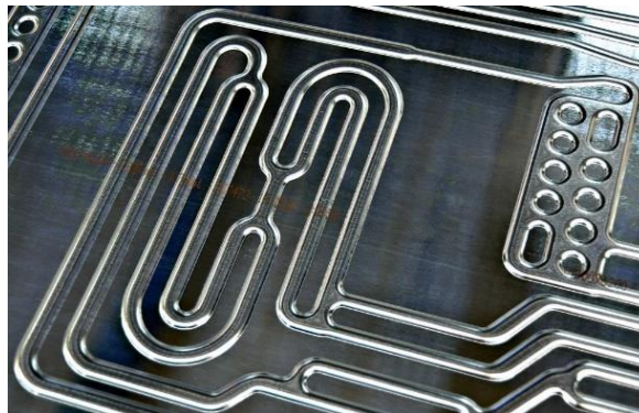
Slika 5-7. Alumijski pločasti toplinski prijenosnik (Talum (g), 2019)
