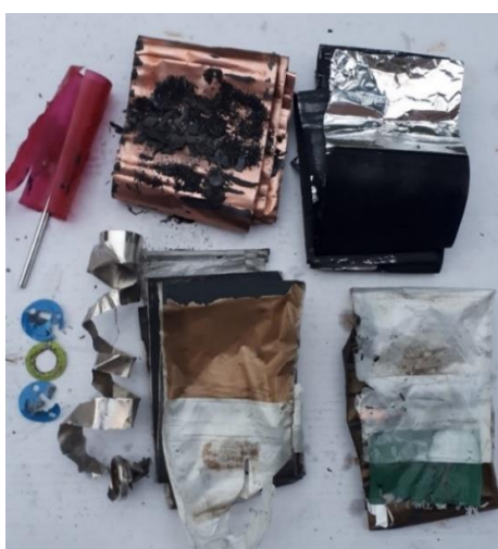
Slika 10-14 Dijelovi Li-ion baterije (razmotani svitak)
