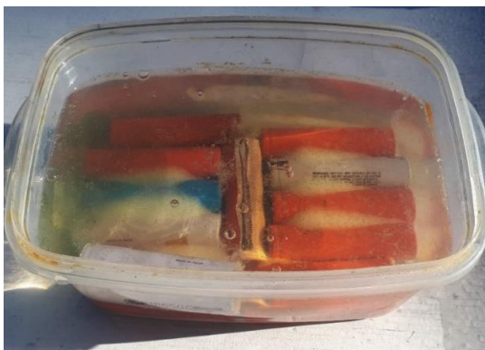
Slika 10-11 Pražnjenje Li-ion baterija u vodenoj otopini NaCl-a (na početku)
