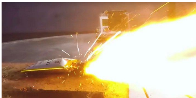
Slika 6-5 Eksplozija litij-ionske baterije (Brown, 2016.)
