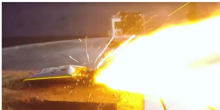
Slika 6-5 Eksplozija litij-ionske baterije (Brown, 2016.)
