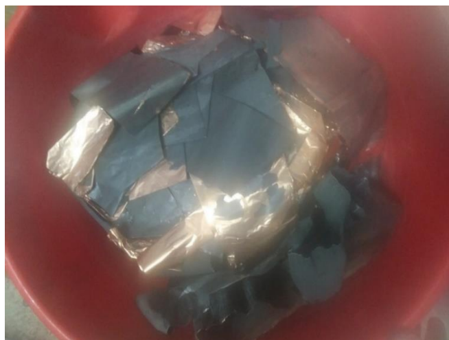
Slika 10-15 Izdvojene aluminijske folije s \text{LiCoO}_2 i bakrene folije s grafitom klase +8 mm
