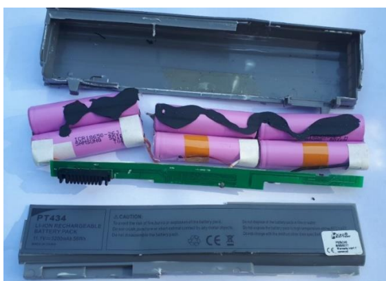
Slika 10-10 Dijelovi baterije prijenosnog računala
