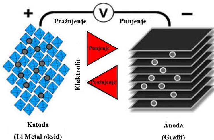
Slika 5-1 Princip rada Li-ion baterije (Buchmann, 2011)
