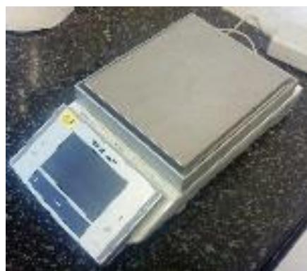
Slika 10-1 Digitalna laboratorijska vaga „Mettler Toledo“
