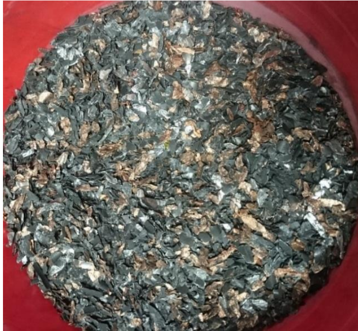
Slika 10-16 Usitnjeni materijal klase -8 mm
