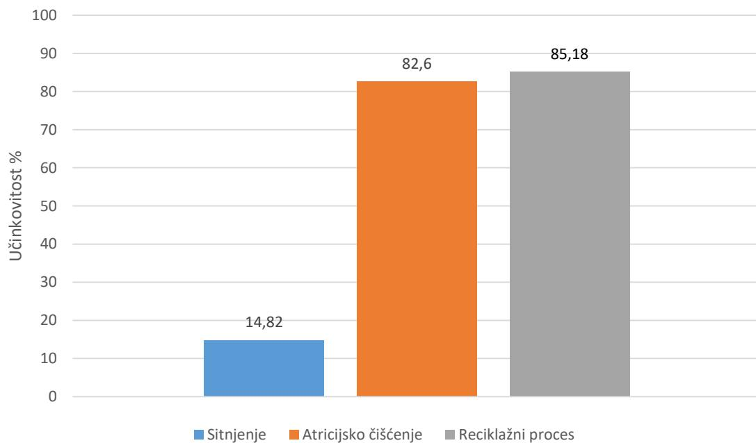
**Slika 11-4** Učinkovitost oslobođanja elektrodnog materijala za sitnjenje, atricijsko čišćenje i ukupni reciklažni proces prikazana preko iskorištenja korisne komponente ( $I_k$ )
