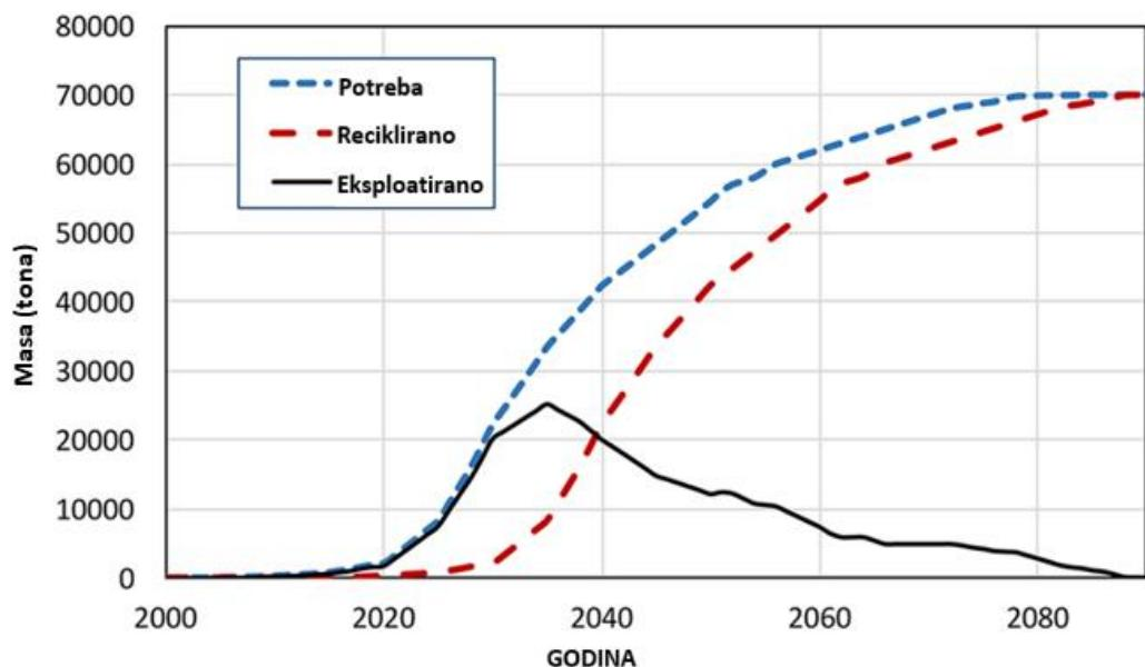
Slika 6-4 Projekcija izvora litija za proizvodnji litij-ionskih baterija (Gaines i dr., 2018.)
