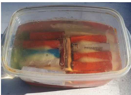
Slika 10-11 Pražnjenje Li-ion baterija u vodenoj otopini NaCl-a (na početku)
