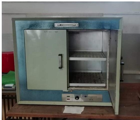
Slika 10-5 Električni sušionik „Instrumentaria ST-06“
