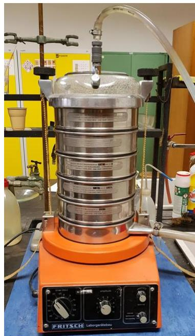
Slika 10-3 Laboratorijski vibracijski uređaj za sijanje „FRITSCH Analysette 3“
