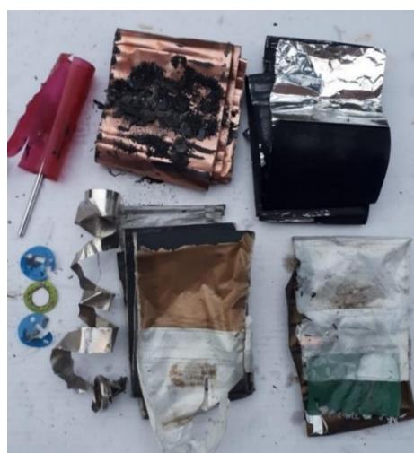
Slika 10-14 Dijelovi Li-ion baterije (razmotani svitak)
