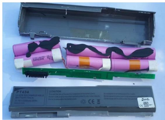
Slika 10-10 Dijelovi baterije prijenosnog računala
