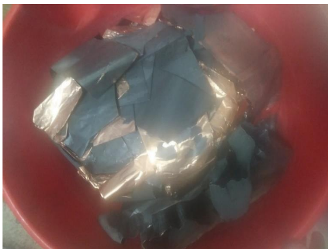
Slika 10-15 Izdvojene aluminijske folije s \text{LiCoO}_2 i bakrene folije s grafitom klase +8 mm
