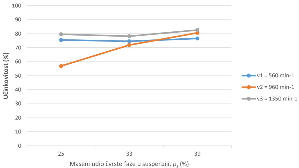
**Slika 11-1** Učinkovitost oslobađanja elektrodnog materijala atricijskim čišćenjem (15 min) prikazana iskorištenjem korisne komponente ( $I_k$ ) kao funkcije gustoće suspenzije ( $\rho_s$ ) i brzine vrtnje impelera ( $v$ )
