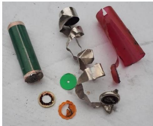
Slika 10-13 Dijelovi Li-ion baterije
