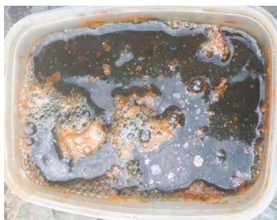
Slika 10-12 Pražnjenje Li-ion baterija u vodenoj otopini NaCl-a (nakon 24 sata)
