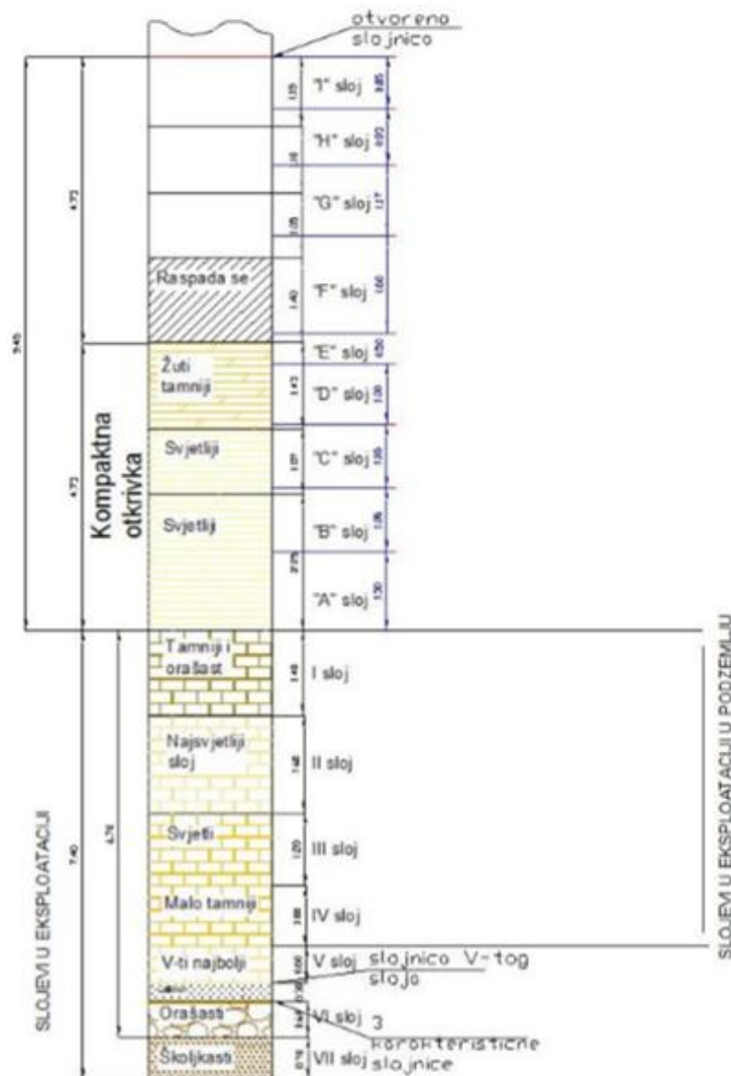
Slika 3-5 Profil naslaga kroz ležište (Hrženjak, 2014)
