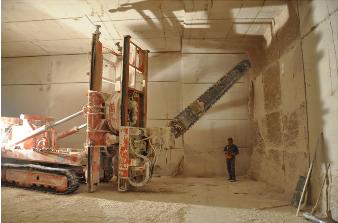
Slika 3-2 Lančana sjekačica (Kamen Pazin, 2020)
