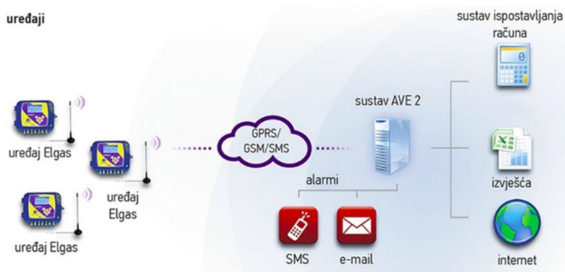
Slika 2-6. Način funkcioniranja GPRS/GSM tehnologija (Energetika.net 2018)
