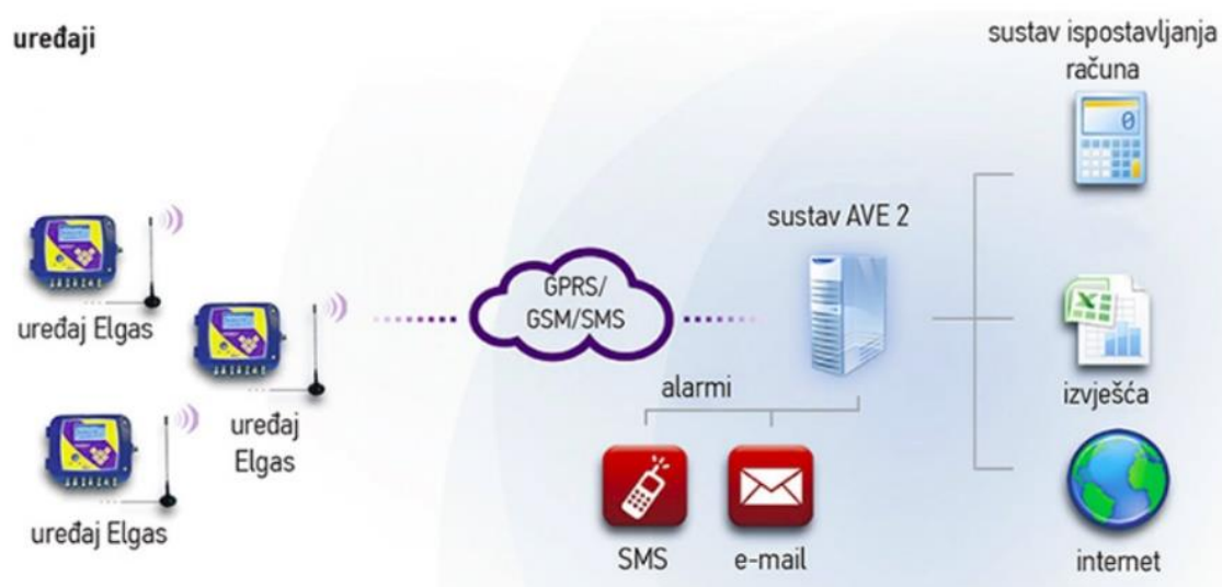
Slika 2-6. Način funkcioniranja GPRS/GSM tehnologija (Energetika.net 2018)
